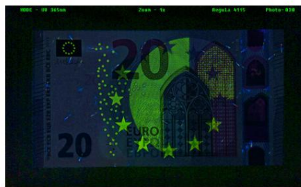
Comparación del billete examinado en luz ultravioleta (365 nm) con el billete de referencia de la base de datos
