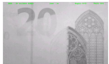
Fragmento del billete examinado bajo luz incidente infrarroja (830 nm). Aumento 2x en el monitor
