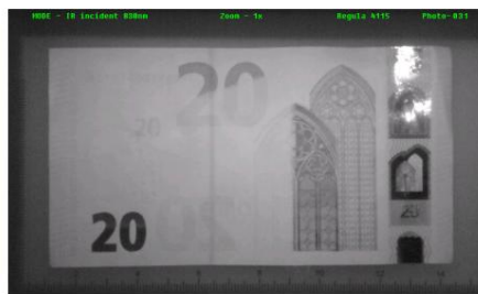
Comparación entre el billete examinado bajo luz incidente infrarroja (830 nm) con el billete de referencia de la base de datos
