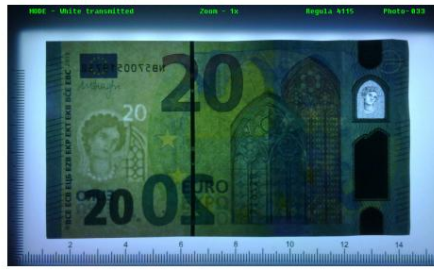
Comparación entre el billete examinado en luz transmitida blanca con el billete de referencia de la base de datos
