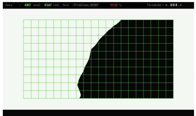
Medición automática del área del billete (área residual)
